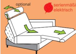
Fußpolster und Rücken lassen sich über zwei Motore einzeln ansteuern und individuell einstellen. Vor dem Öffnen des Fußpolsters senkt sich der Sitz mit den Rücken deutlich ab.
